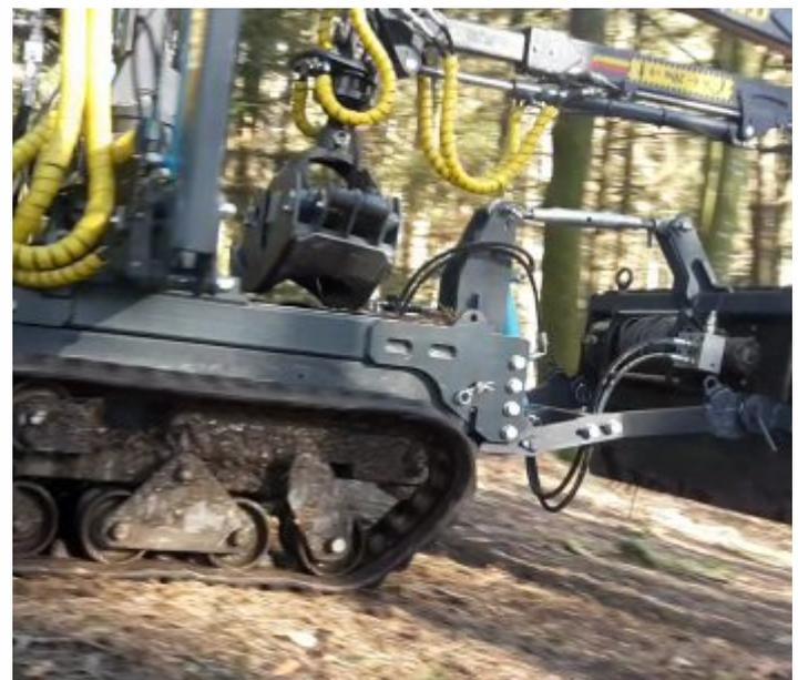
3 Punkt Fronthydraulik mit Seilwinde
