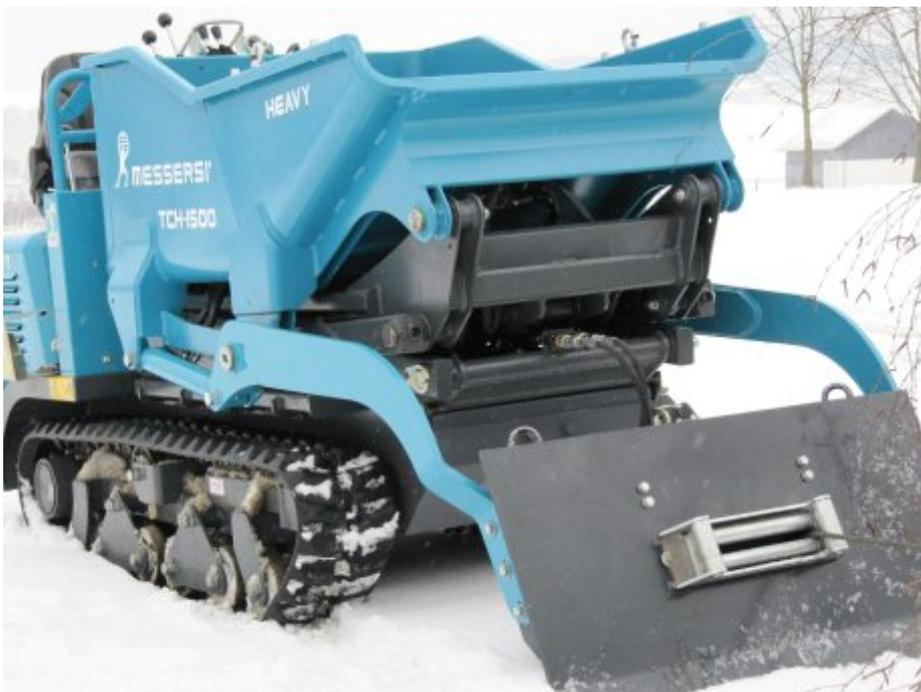
Optimale Abstützung im Windenbetrieb durch das Frontschild.
