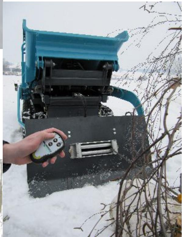
Bedienung der hydraulischen Winde
