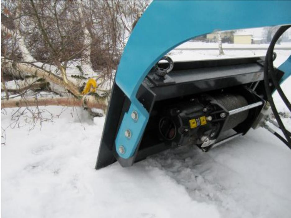
Diese Version des Aufbaus empfehlen wir für das Fällen mit der hydraulischen Winde und zum Transportieren von Kurzholz (max 1m.) in der Kippmulde. Vor allem für Durchforstungsarbeiten, bei denen keine Rückegassen angelegt sind aber auch an Steilhängen und Durchfahrtsbreiten ab 1,1m, ist der perfekte Einsatzort für diesen Raupendumper.
